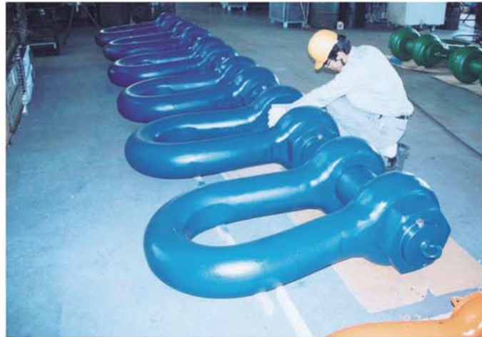
▲使用荷重800トン 世界最大級の鍛造シャックル
